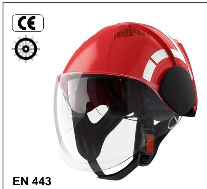
Casco specifico per Vigili del Fuoco realizzato con calotta in materiale di fibre composite, bardatura interna regolabile nelle taglie da 52 a 63 con materiale di conforto a contatto con la pelle, sottogola a tre punti di attacco munito di fibbia a sgancio rapido, schermo protettivo in policarbonato con trattamento antiappannante ed antigraffio. Il visore ha spessore 2,2-2,4 mm e lunghezza di 180 mm circa.
