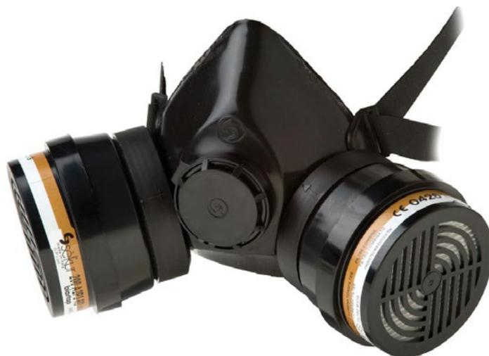
Respiratore per uso agricolo, in confezione termosaldada, costituito da una semimaschera di taglia universale conforme alla norma **UNI EN 140** e due filtri combinati Serie 200 A2 P3 R D. La carta filtrante, contraddistinta dal marchio Biostop\*, presenta un trattamento fungicida e battericida che risulta particolarmente utile quando gli aerosol da cui occorre proteggersi sono di tipo biologico.
